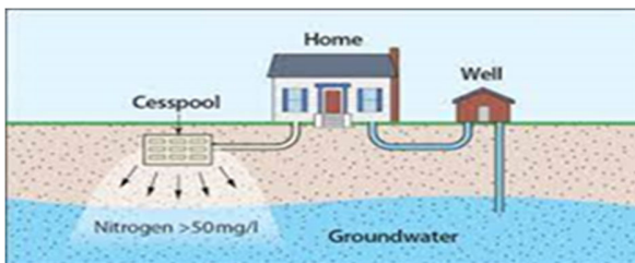
Малюнок 4. Схематичний приклад вигрібної ями Джерело: groundstone.ca
