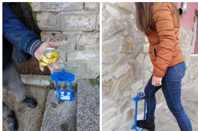
Фигура 32. Пресите за пластмасови бутилки намаляват с 80% обема на пластмасовите бутилки и алуминиевите кенчета. Снимка: Земя завинаги
