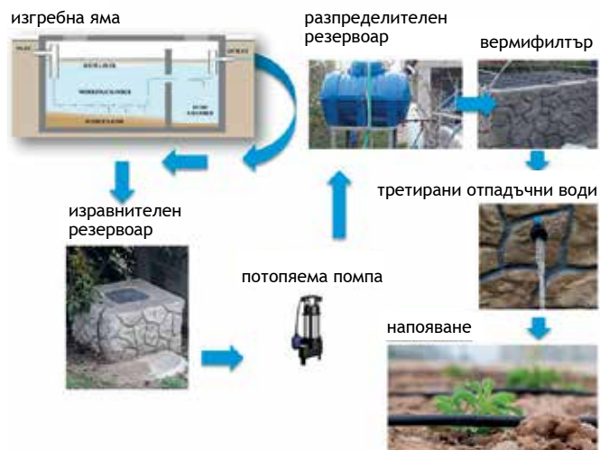
Фигура 16: Схема на демонстрационен вермифилтър, изграден от асоциация WisDOM за селско домакинство в Молдова
