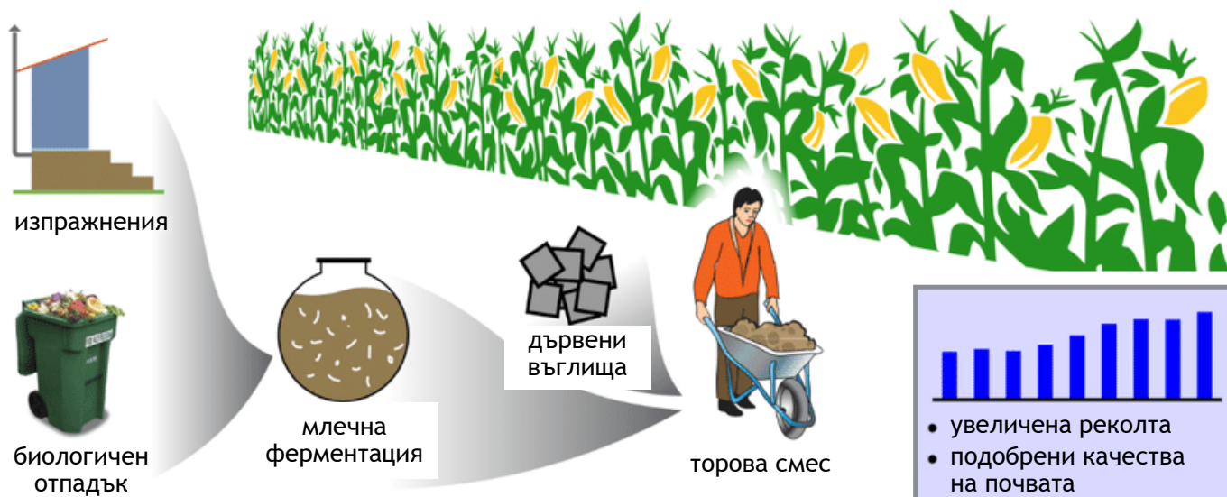
Фигура 17: Тера прета санитарна система (TPS) 37
