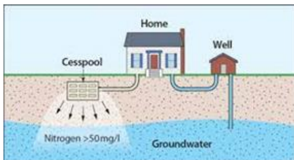
Figura 4. Un exemplu schematic de fosă septică. Sursa: groundstone.ca
