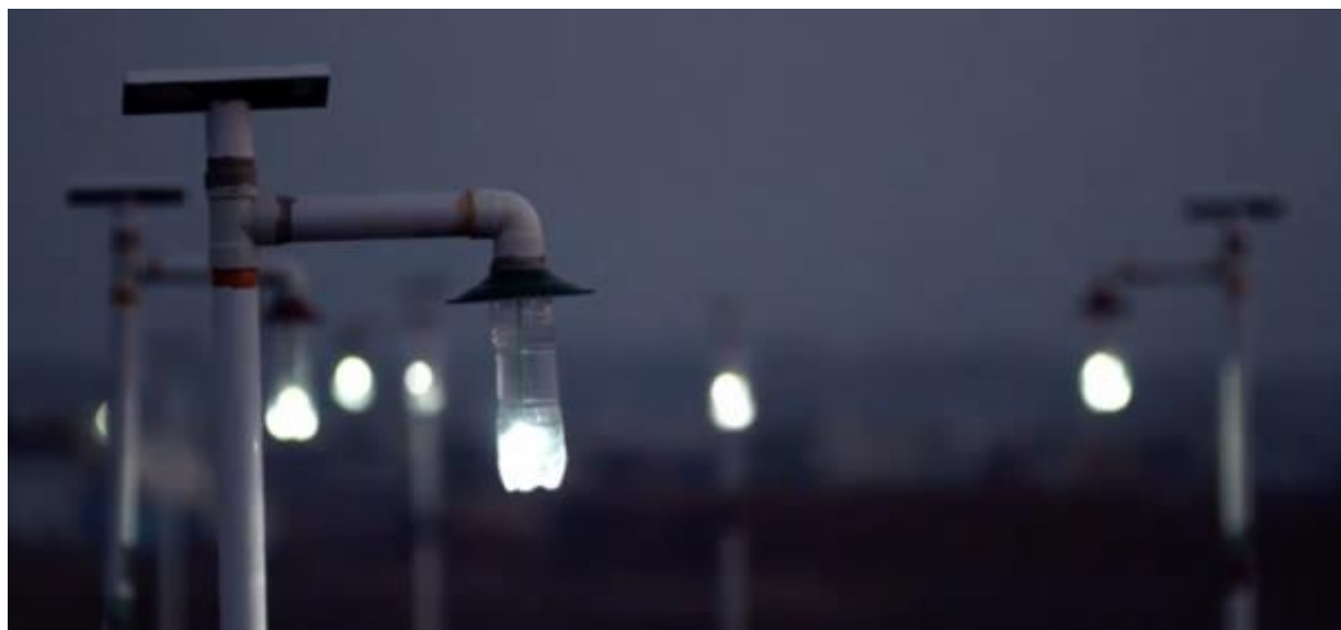
Figura 40. Iluminări exterioare din sticle de plastic, Haiti. Source: literoflight
