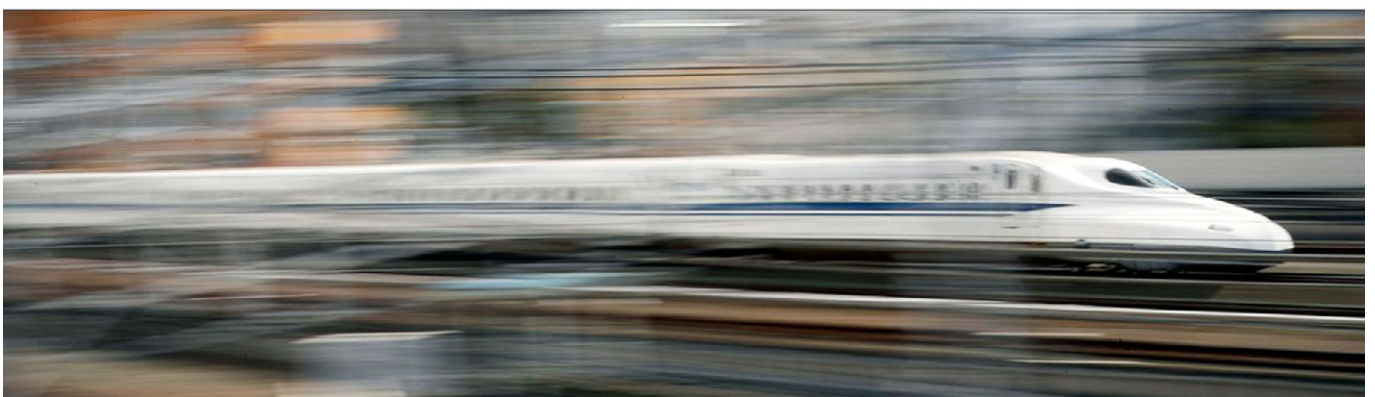
☒ Високоскоростният влак, проектиран в Япония, е вдъхновен от формата на клюна на земеродното рибарче. Това позволява движение с по-малко триене и загуба на енергия.
